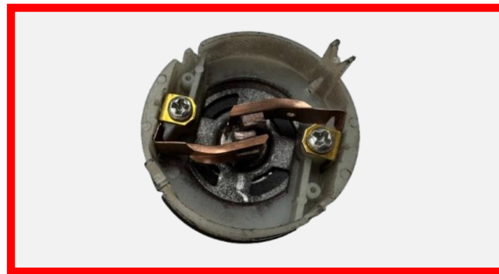
Износ и замыкание щеток электродвигателя
