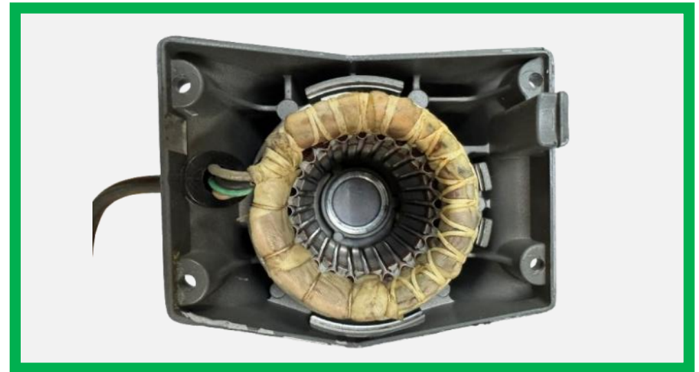
Статор с медной обмоткой
